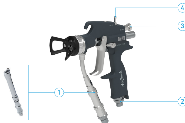
1 Farbrohr mit kurzem oder langem Filter, 2 Lufteingang, 3 Rundstrahlregulierung, 4 Flachstrahlregulierung
